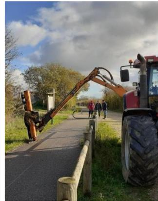
*Dans l'ordre des photos, sécateur mécanique, épareuse à marteaux broyeurs, lamier à disques*
